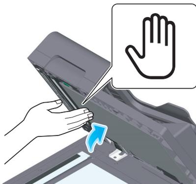
→ Drücken Sie gegen das Handsymbol in der Mitte der **Öffnungs- und Schließführung**, und stellen Sie sicher, dass die **Öffnungs- und Schließführung** sicher verriegelt ist.
