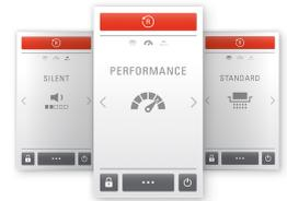
Intuitive Bedienung und mehrsprachige Menüführung erfolgt über das hochauflösende 4,3" Touchdisplay. Relevante Informationen wie Betriebsmodus und Zustandsmeldungen werden angezeigt. Verbrauchsmaterial, Maschinen- und Kontaktdetails können eingesehen werden.
